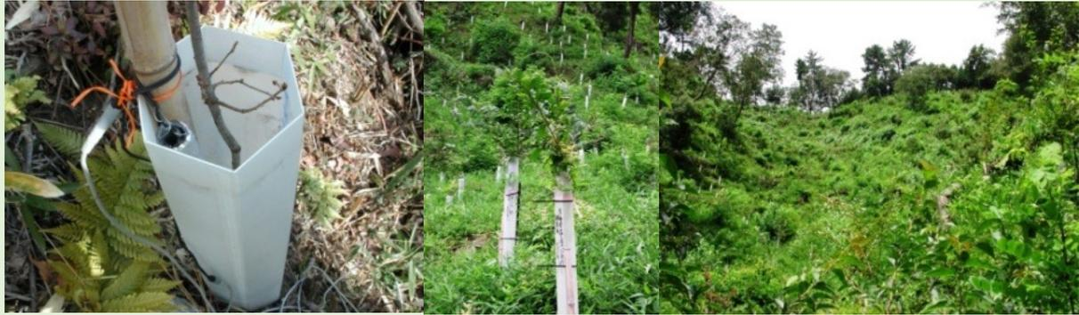
\* 温度センサーは直射光が当たらないようにプラスチック筒で覆い、そのプラスチック筒をアルミ箔で包む。
