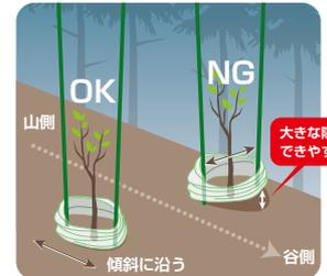
支柱は**傾斜方向に沿って山側と谷側**に打ち込みます。山側-谷側に打ち込むことにより地際に隙間なく設置することができます。
